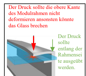
Abbildung 1a: Druck auf die Klemmenstellen
